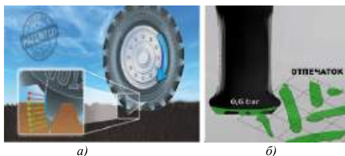
Рисунок 4. Ключевые особенности шин VT-TRACTOR: а) эвольвентные грунтозацепы; б) мягкие борта S-LINE
