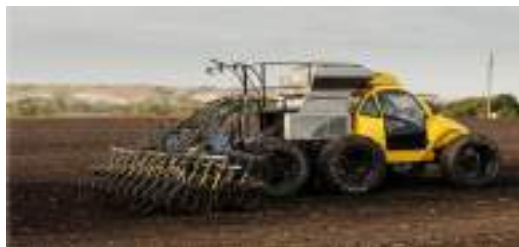
Рисунок 3. Пневматический посевной комплекс «Любава»
