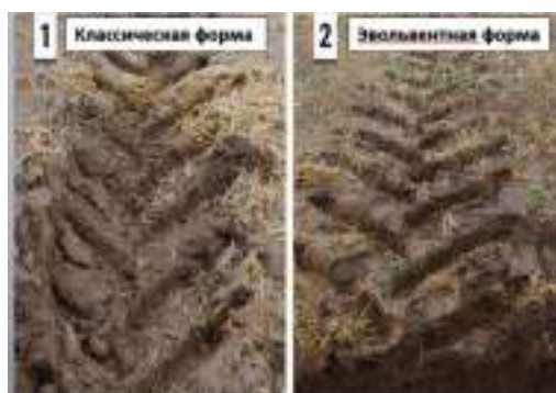
Рисунок 5. Результат применения грунтозацепов различающихся по форме
