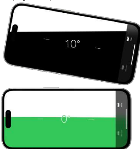
Figura 11. Măsurarea înălțimii unghiulare cu ajutorul telefonului mobil.
