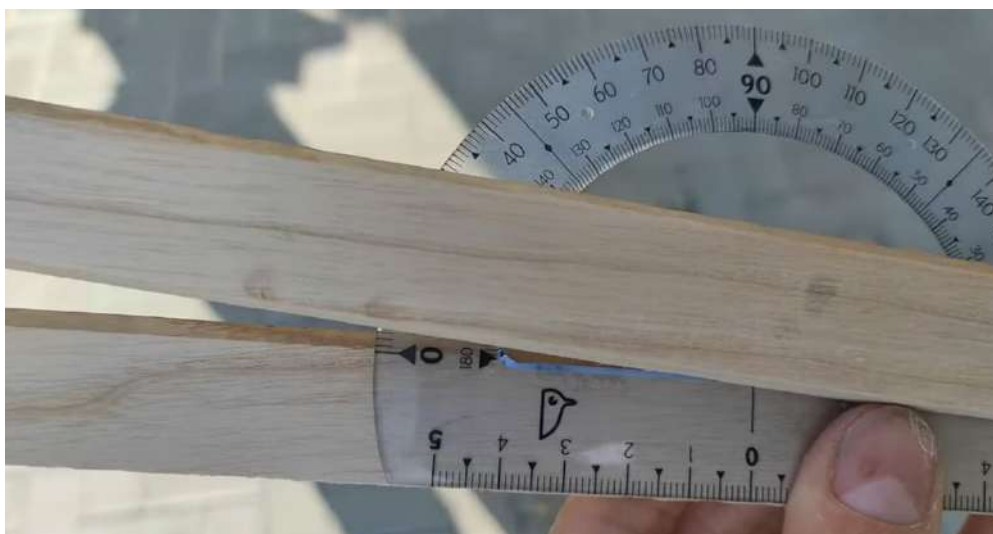
Figura 10. Dispozitiv școlar pentru determinarea înălțimii unghiulare.
