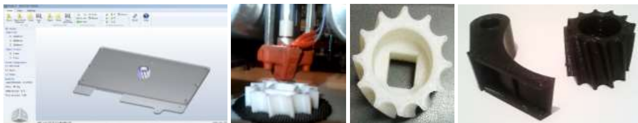
Figura 5. Elaborarea elementelor constructive cu imprimanta 3D.
