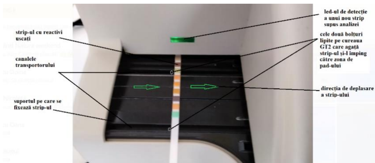
Fig. 1. Strip-ul cu reactivi și probă pus manual în zona exterioară a analizorului
