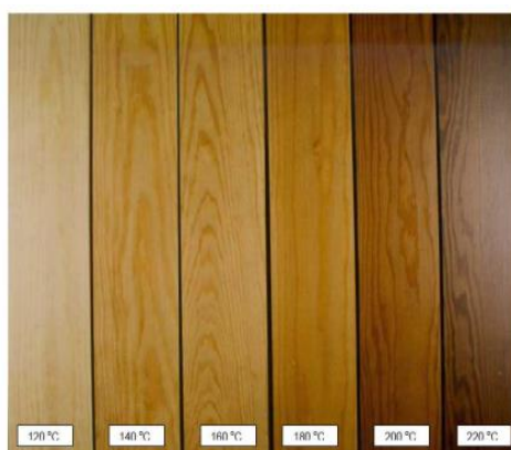
Figura 1. Gradație culorii termolemnului în dependență de temperatura aplicată
